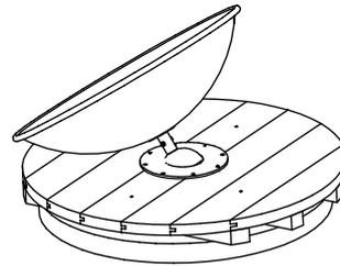
**2. Gummiabdeckung entfernen (Schraubeinsatz Torx 25). Gegebenenfalls Vertiefung in Bodenmitte reinigen und Drehlager freilegen.**
