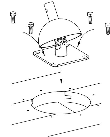
**9. Gummiplatte aufschrauben und Wackelwanne mit Drehlager verbinden.**
