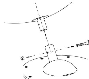
**3. Schrauben der Fußplatte lösen und Drehlager entnehmen (Ratsche mit Verlängerung).**
