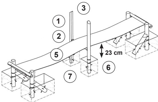
Falls das Durchhangbild nicht gleichmäßig ist, kann durch Einsetzen von Unterscheiben Ø 68 mm (**Detail A**) zwischen Standpfosten und Querbäumen an der Seite mit dem größeren Durchhang Abhilfe geschaffen werden. Ebenso ist es möglich, an der zu straff gespannten Seite durch Abhobeln der Kontaktstelle zwischen Standpfosten und Querbäumen (**Detail B**) einen Durchhangausgleich zu schaffen.
